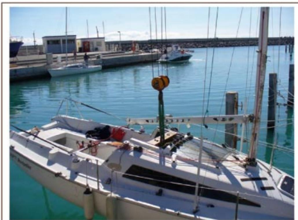
Penser à régler la position de la planche pour que le bateau s'incline légèrement vers l'avant afin de dégager le mât de la grue.
